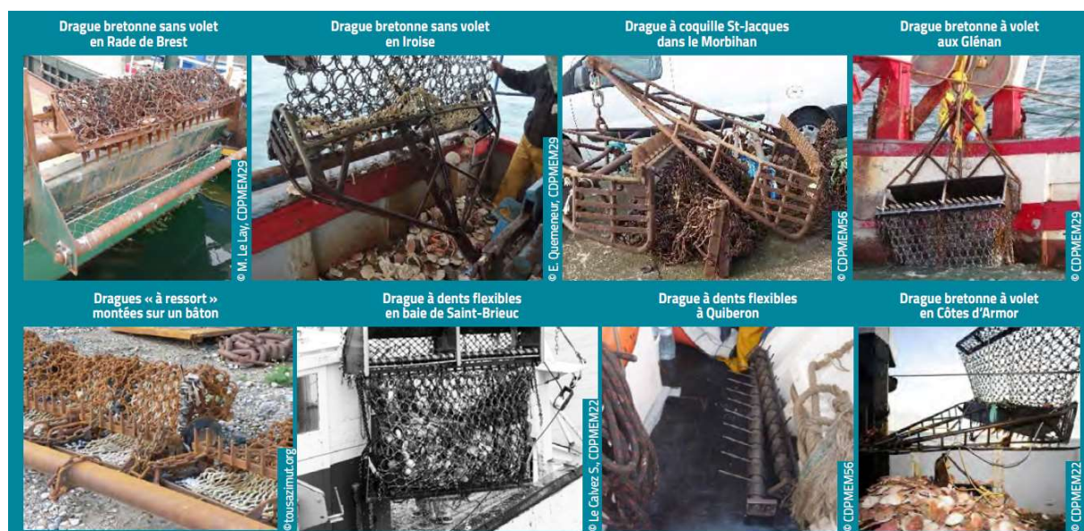
Figure 5 : Illustration de la diversité des dragues en Bretagne pour la coquille Saint-Jacques
