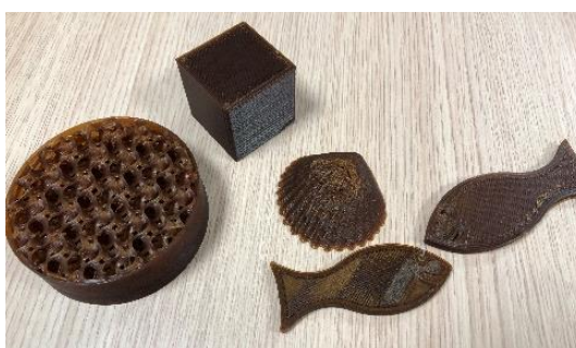
Figure 43 : Pièces imprimées en 3D à partir du filament réalisé à partir de poudre de chair de coque
