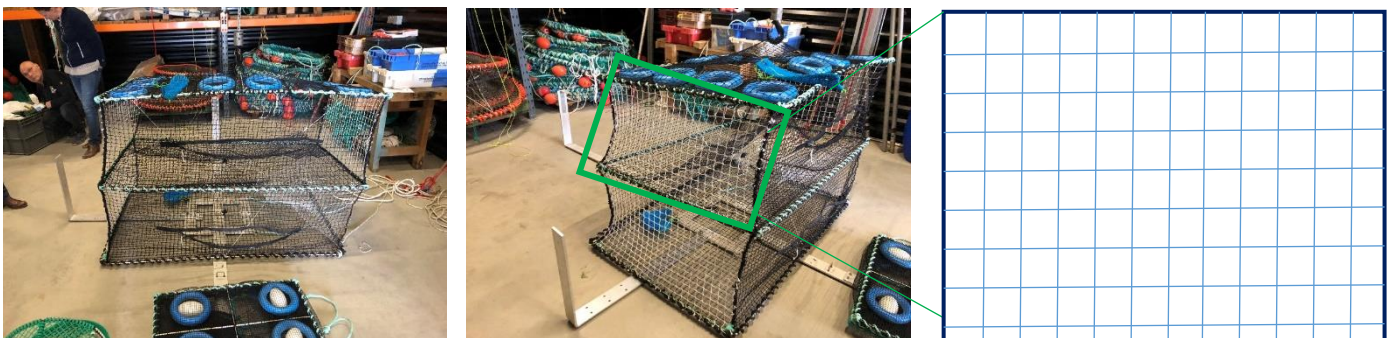
Figure 47 : photographie d'une nasse à poisson et représentation du schéma d'un panneau
