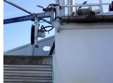
Fig. 10 : Stockage de ligne-mère
