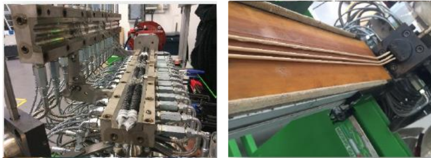
Figure 39 : extrudeuse bi-vis pour formulation matière
