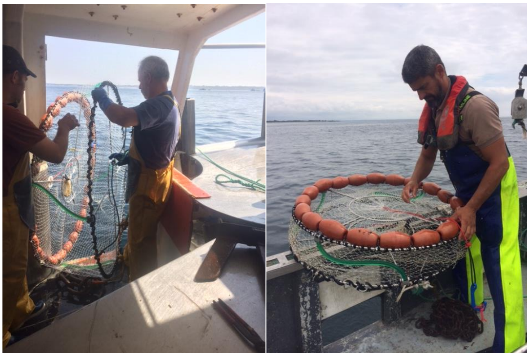
Figure 16: Essais des prototypes de nasses à bord des navires de pêche partenaires
