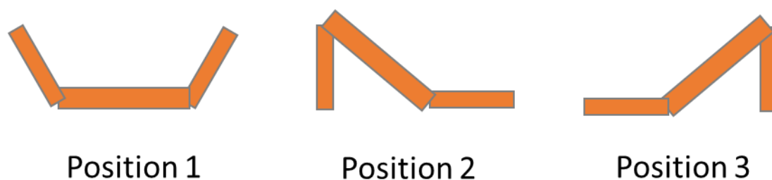
Figure 4. Mise en mouvement des parties mobiles des tapis M, chaque position est tenue pendant 10s.
