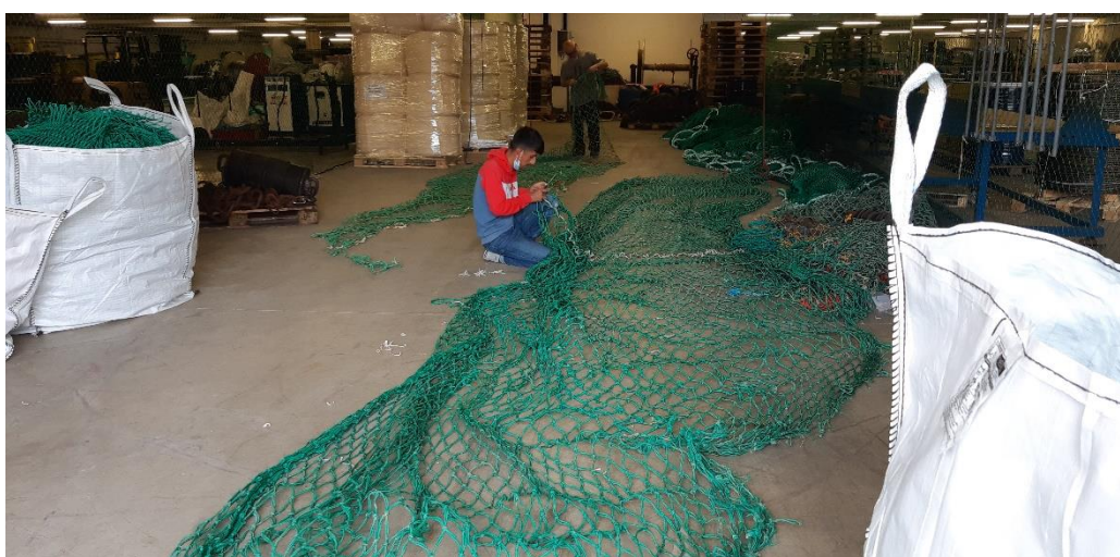
Figure 20 : Opération de démontage d'un chalut dans les locaux de Tecnorope
