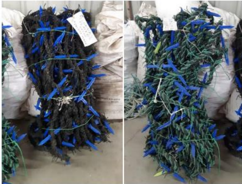
Exemple de conception d'engins de pêche à base de chaluts en PE usagés
