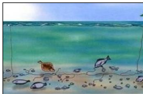
Figure 7 : Schéma d'une palangre benthique. Source IFREMER
