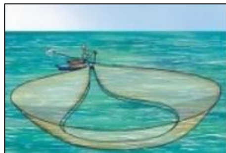
Figure 11 : Schéma de pêche à la senne tournante. Source IFREMER
