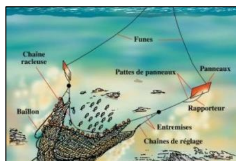
Figure 12 : Schéma de la pêche au chalut de fond. Source IFREMER
