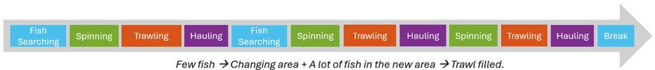
Finalement, on peut construire ainsi les signaux “artificiels” de simulation comme illustré dans les figures ci-dessous ; notons qu’ici on modélise aussi la masse de poissons cumulée dans le navire, car cette variation de masse pourra être considérée à termes dans l’analyse de la consommation du navire.
