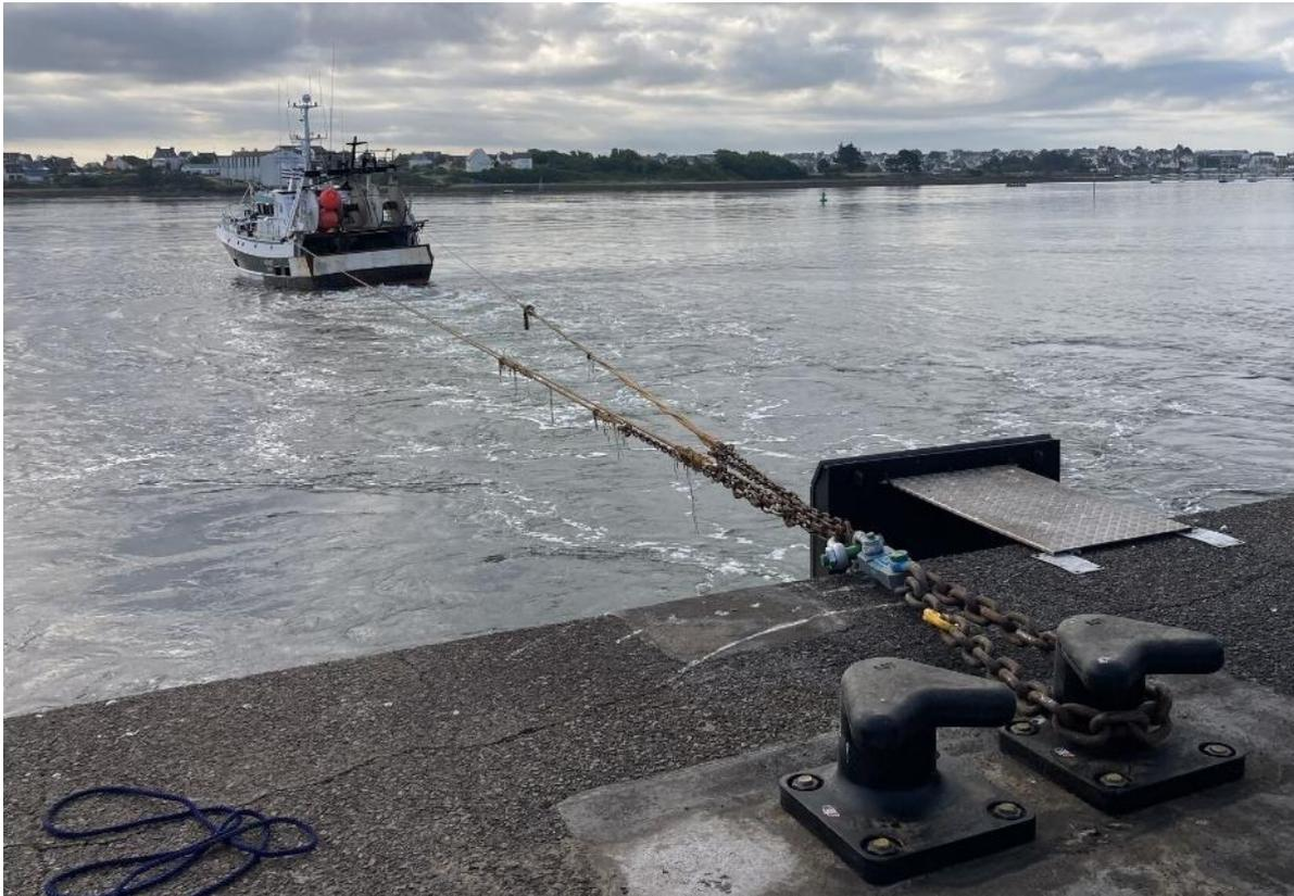
Figure 30. Photo de l'essai au point fixe - un dynamomètre est montée entre les funes et la chaîne d'amarrage pour mesurer la force de traction donc la poussée de l'hélice à vitesse nulle.
