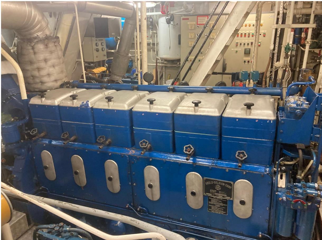
Le moteur thermique retenu pour l'architecture hybride projetée est un **Mitsubishi S6R2**, capable de délivrer jusqu'à **691 kW à 1406 RPM**.
