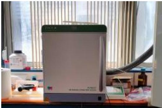
*Figure 4 : Micro-ondes utilisé pour l'analyse des matières grasses*
