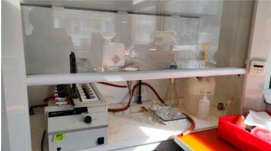
*Figure 3 : Matériel utilisé pour l'étape de chauffage et d'ajout d'acide chlorhydrique 3N*
