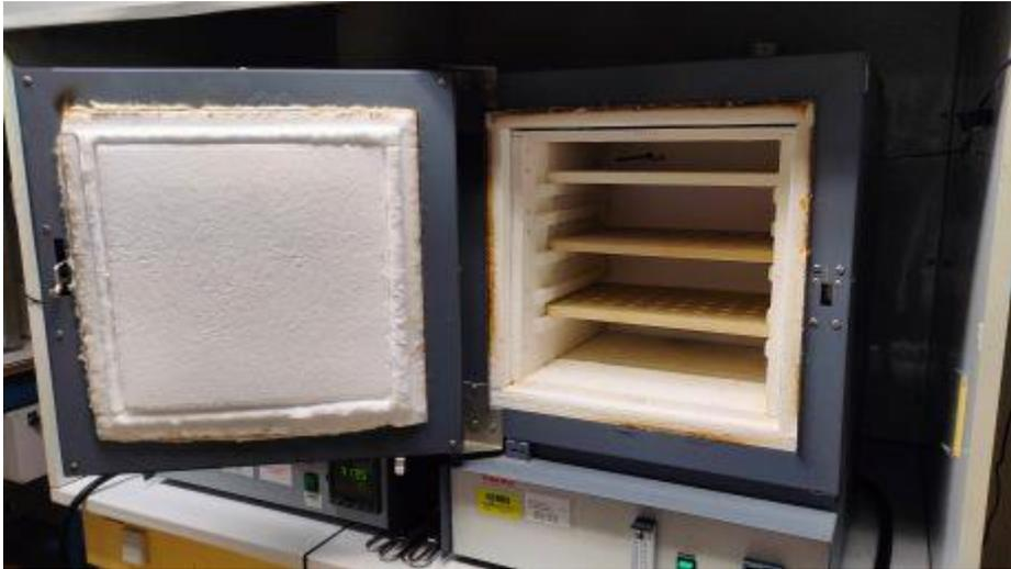
*Figure 2 : Four utilisé pour déterminer les quantités de matières minérales dans les échantillons*
