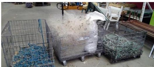
*Figure 1 : Séparations des différents éléments du filet lors de l'étape de pré-*
