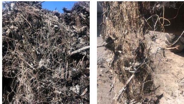
Figure 8 : Aperçu des morceaux de filet à j+20 dans le lot de compost
