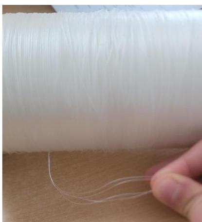
Le fabricant de filet n’avait pas la capacité de réaliser un multi-monofilament de 10 et a donc proposé de réaliser un multi-monofilament de 12. En effet, contrairement au cahier des charges d’origine, les machines du fabricant permettent de réaliser du twistage de 3 ou de 4 monofilaments (multiple qui ne permet pas d’avoir un multi-monofilament de 10)
