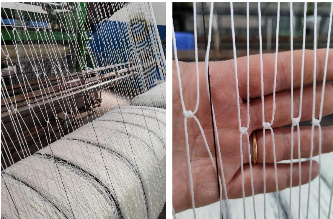
Figure 14 : Fabrication des nappes intérieures (gauche) 0.20mm\*4 et extérieures (droite) 0.20mm\*12
