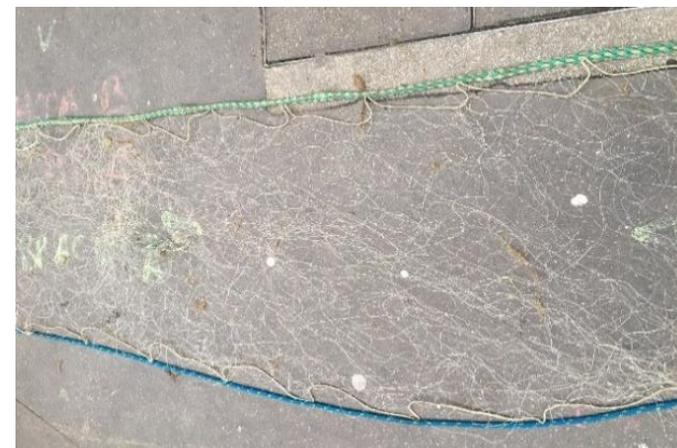
*Figure 3 : Tronçon de filet biodégradable déroulé*
