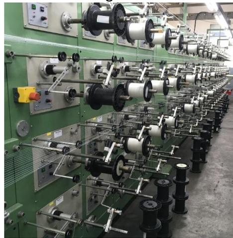
figure 19: Photos de la ligne d'extrusion-filage industrielle
