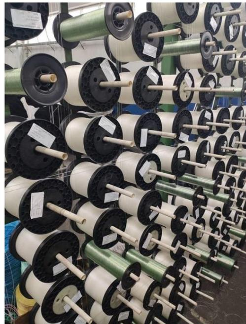
*figure 22:production de filets à partir de monofilaments 0.60 mm*
