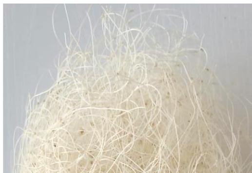
Figure 1 : Morceau de filet SEA®214 avec un diamètre de monofilament de 0.35 mm
