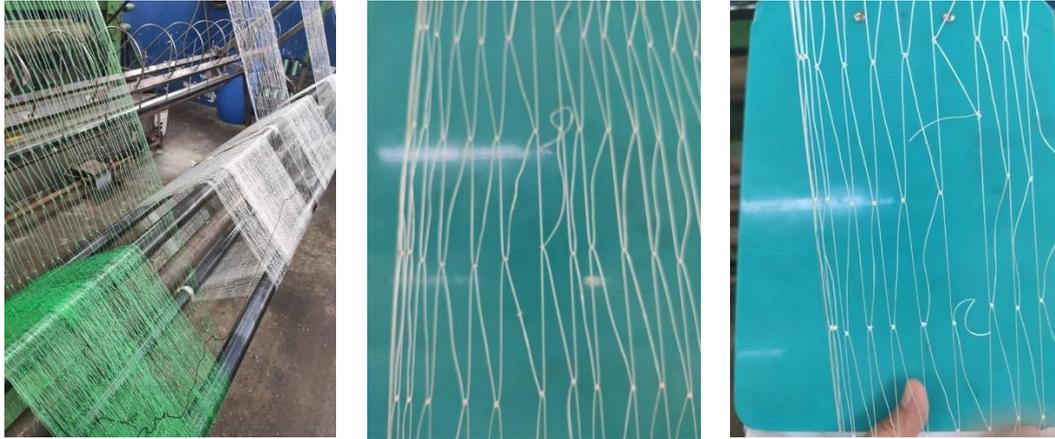
*figure 23: déformation de la maille durant la production de filets à partir de monofilaments 0.35 mm.*
