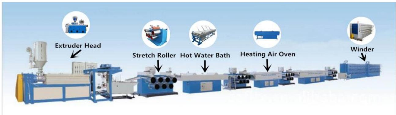
Figure 10 : Schéma de la ligne d'extrusion du fabricant portugais
