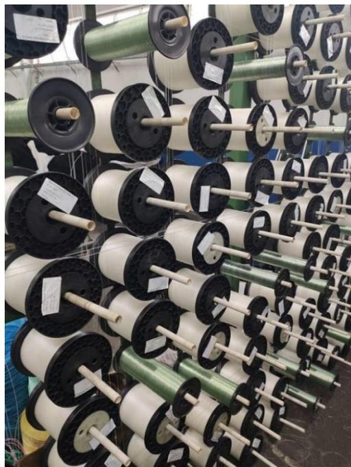
Figure 13 : Fabrication des nappes extérieures 0.33mm
