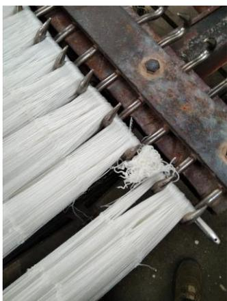
Figure 16: Casse d'une nappe de filet lors de la thermofixation
