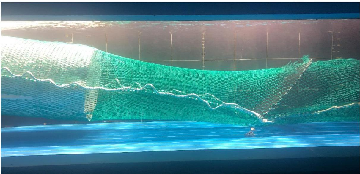
*Figure 28 : essai au bassin d'essais de Lorient du dispositif d'échappement dans la rallonge avec bâche pour la vidéo*
