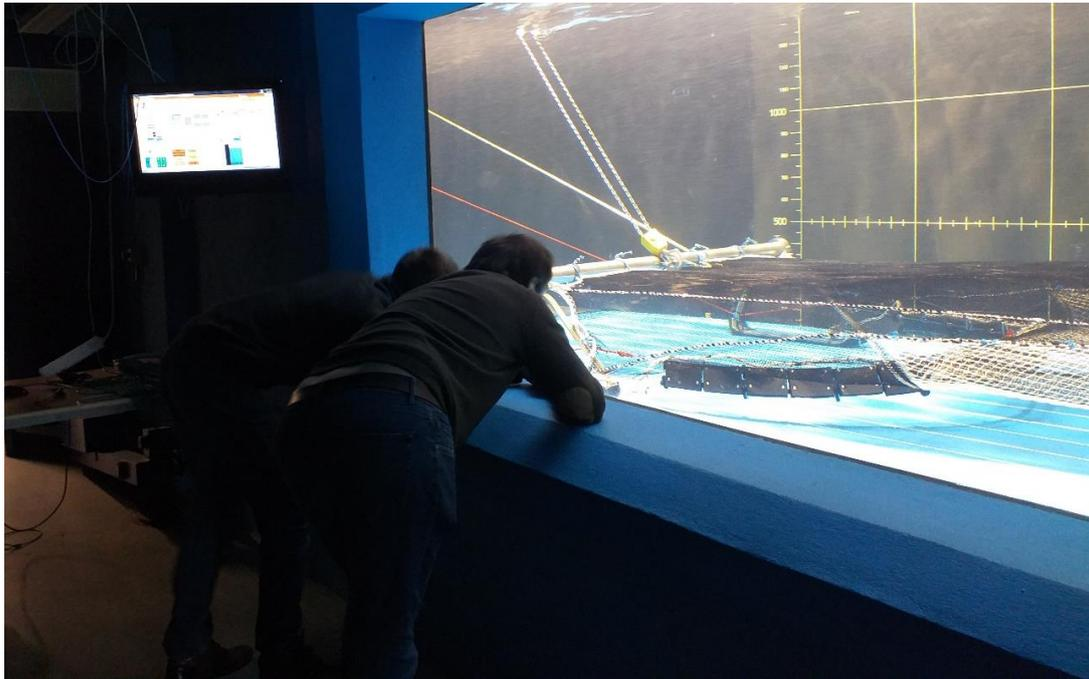
*Figure 23 : Développement du prototype de chalut à perche intelligent au bassin d'essais de Lorient*
