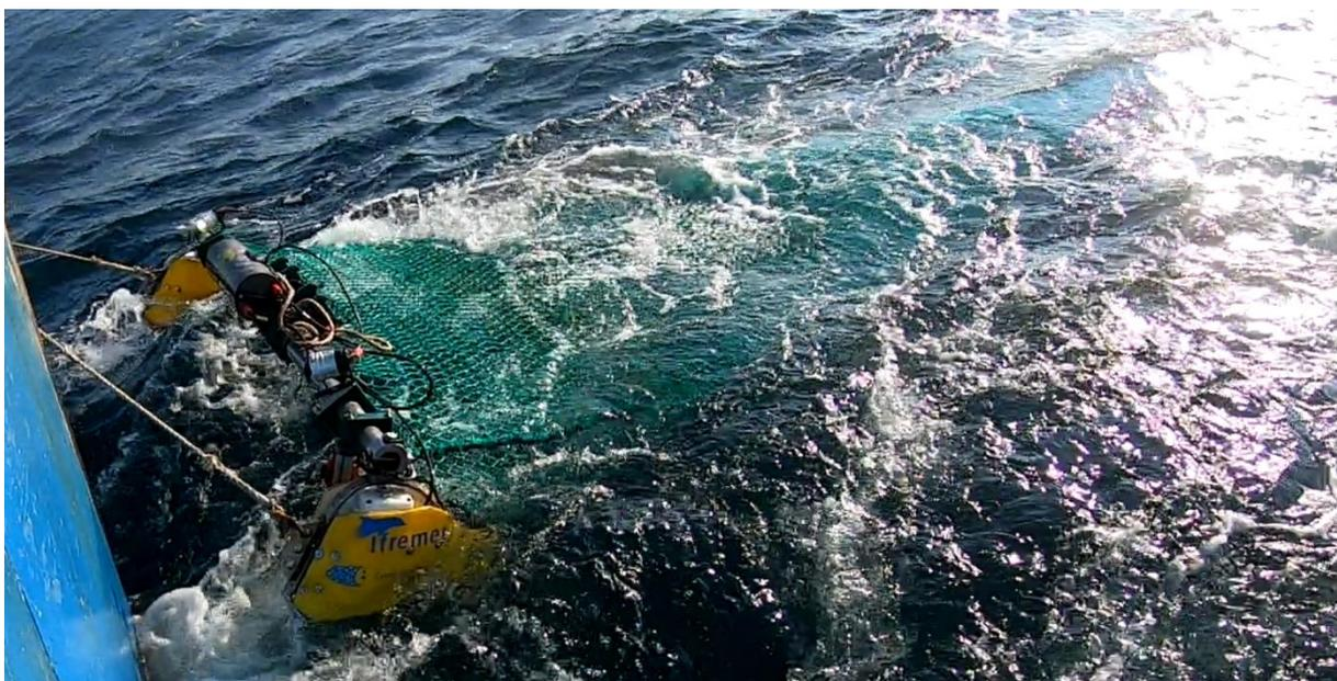
*Figure 24 : essai en mer du prototype de chalut à perche intelligent*
