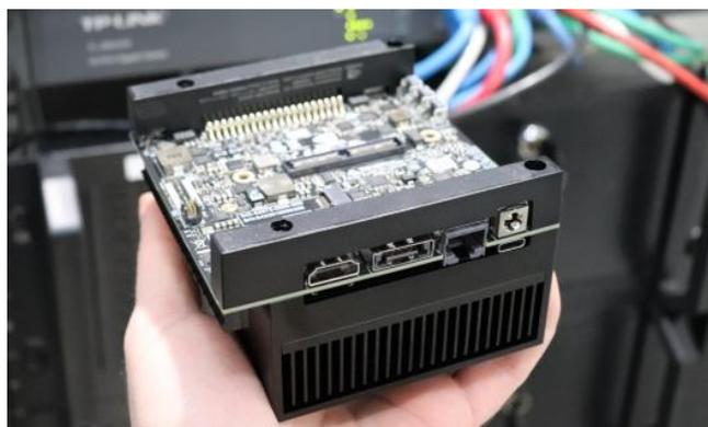
Figure 11 : Carte NVIDIA Jetson avec GPU embarquée.
