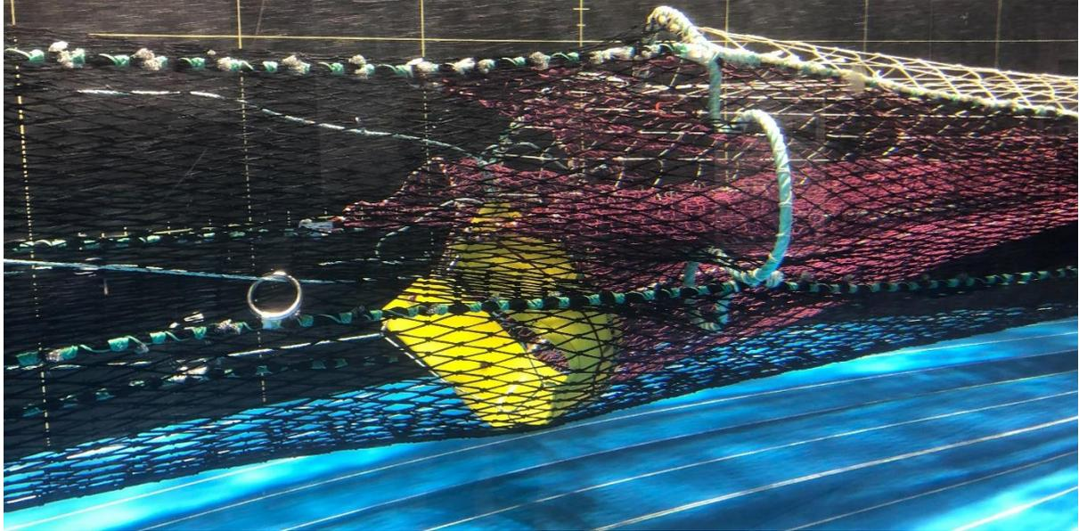
*Figure 27 : essai au bassin d'essais de Lorient du dispositif d'échappement dans la rallonge*
