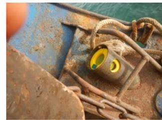
**Bras : 6m acier + chaîne ; Triangle acier de 20 cm de côté + émerillons inox Ø 12 mm**
