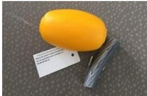
Figure 5 : Ajout d'un flotteur au système d'attache d'une sonde Centi-TD
