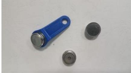
Figure 5. Sondes de température Thermotrack utilisées
