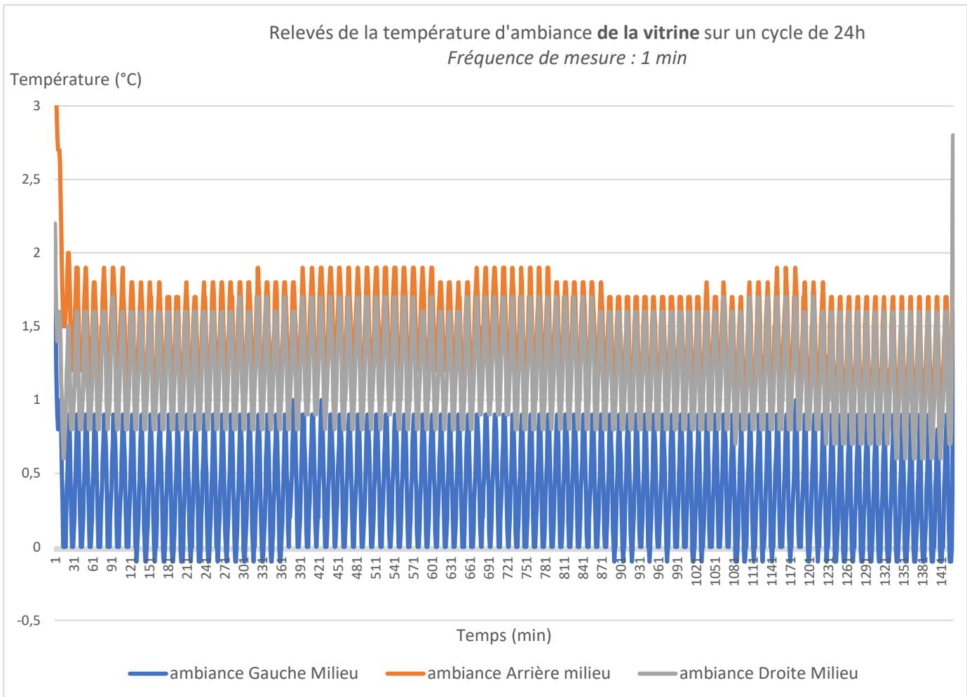
Figure 14. Relevés de la température d'ambiance de la vitrine sur un cycle de 24h (Fréquence de mesure : 1 min)
