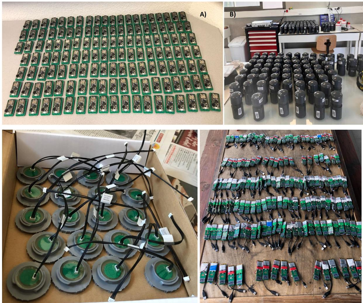
Figure 8: Différentes étapes de fabrication des prototypes v1.2, lot de cartes électroniques assemblées (en haut à gauche), lot de boîtiers assemblés (en haut à droite), lot de bouchons assemblés avec la carte capteur de pression intégrée (en bas à gauche), lot de cartes électroniques assemblées avec la batterie et le câble USB.
