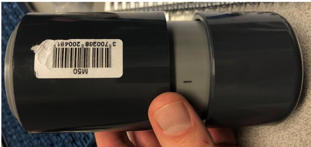
Figure 4: Boîtier assemblé à partir de tubes PVC pression.
