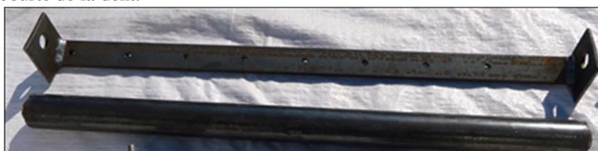
Figure 3: Photo d'une barre sur laquelle se fixent les dents N-Virodredge.
